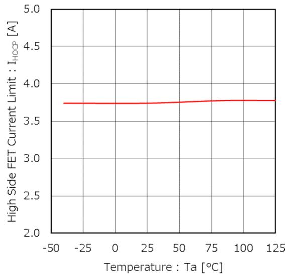
Figure 12. High Side FET 電流制限 vs 温度
