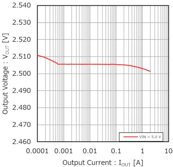
Figure 38. 出力電圧 vs 出力電流 (ロードレギュレーション)
