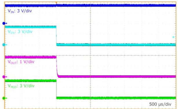
Figure 59.  $R_{Load} = 0.9\ \Omega$  EN シャットダウン波形
