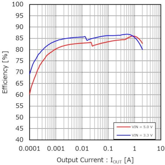
Figure 28. 効率 vs 出力電流
