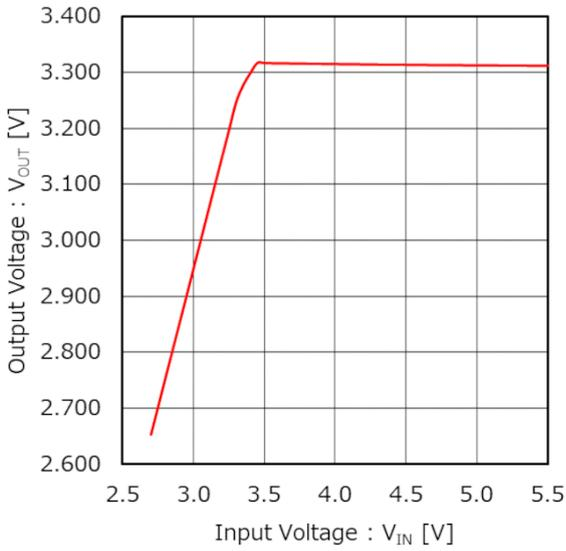
Figure 44. 出力電圧 vs 入力電圧 (ラインレギュレーション)
