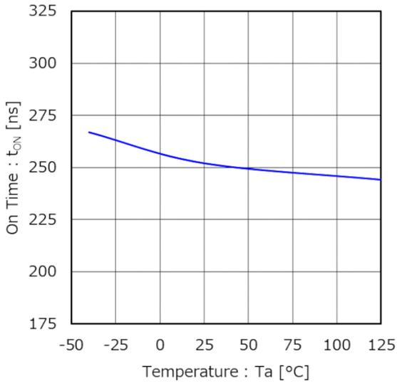
Figure 9. On Time vs 温度
