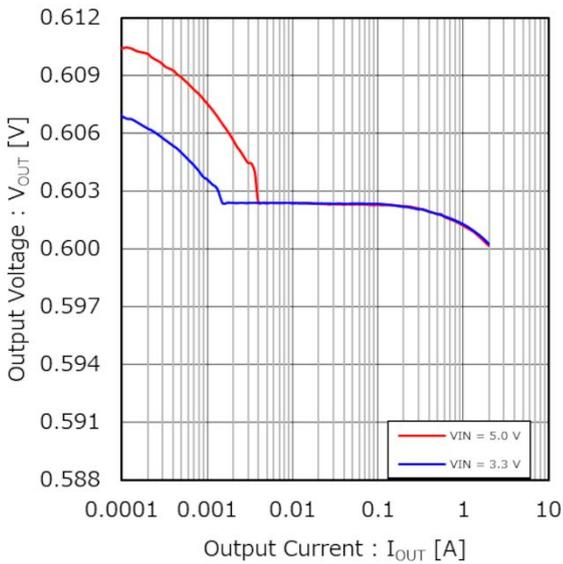
Figure 34. 出力電圧 vs 出力電流 (ロードレギュレーション)
