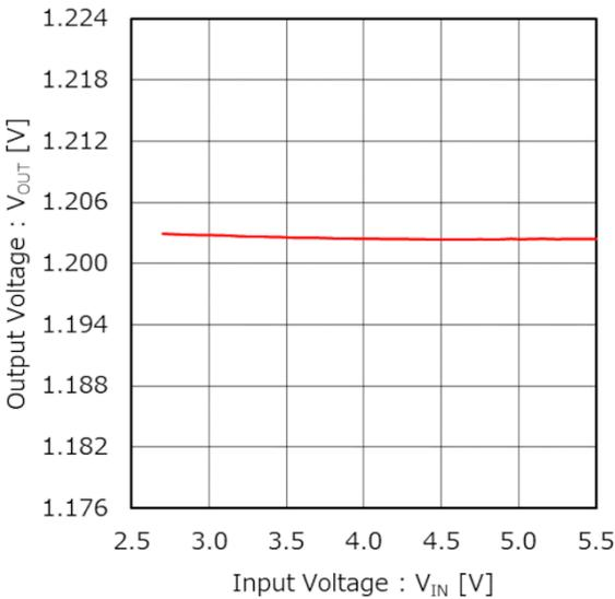
Figure 42. 出力電圧 vs 入力電圧 (ラインレギュレーション) (V<sub>OUT</sub> = 1.2 V, I<sub>OUT</sub> = 1.0 A)
