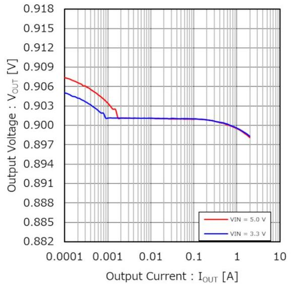
Figure 35. 出力電圧 vs 出力電流 (ロードレギュレーション)
