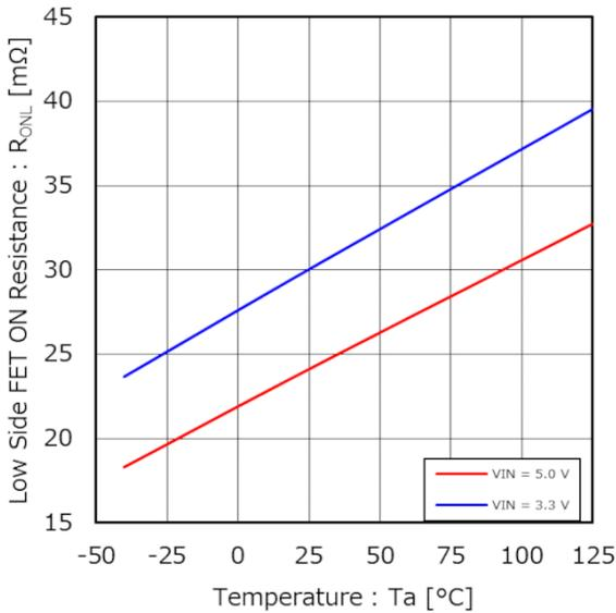
Figure 11. Low Side FET ON 抵抗 vs 温度
