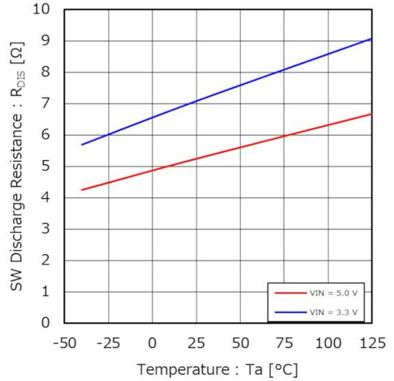
Figure 14. SW ディスチャージ抵抗 vs 温度
