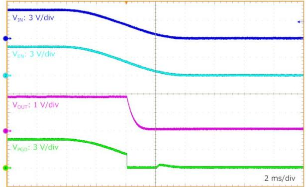
Figure 61. 無負荷 VIN シャットダウン波形
