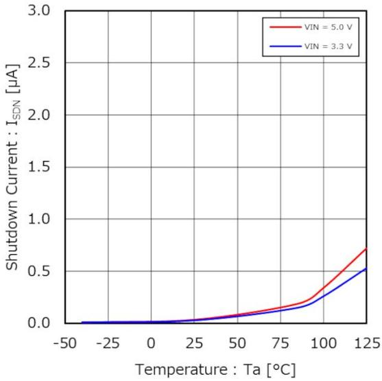
Figure 1. シャットダウン電流 vs 温度
