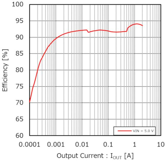
Figure 32. 効率 vs 出力電流
