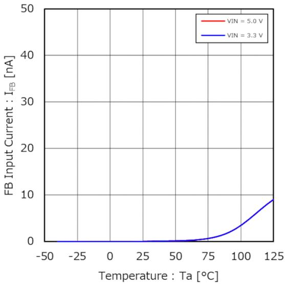
Figure 7. FB 流入電流 vs 温度
