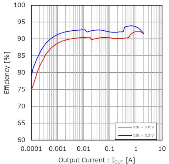
Figure 31. 効率 vs 出力電流
