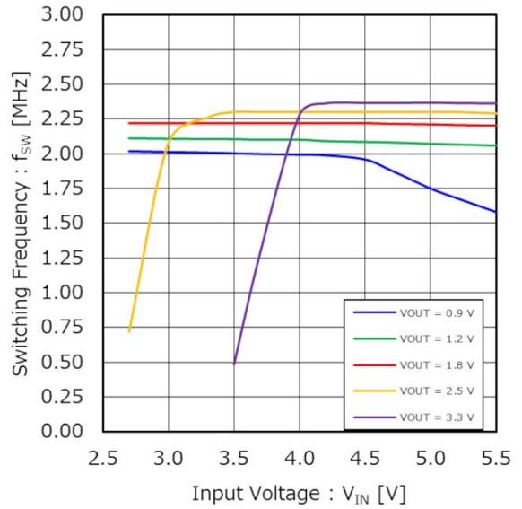
Figure 45. スイッチング周波数 vs 入力電圧
