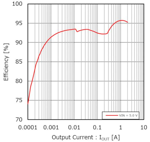
Figure 33. 効率 vs 出力電流
