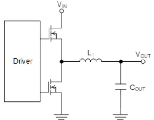
Figure 26. 出力 LC フィルタ回路
