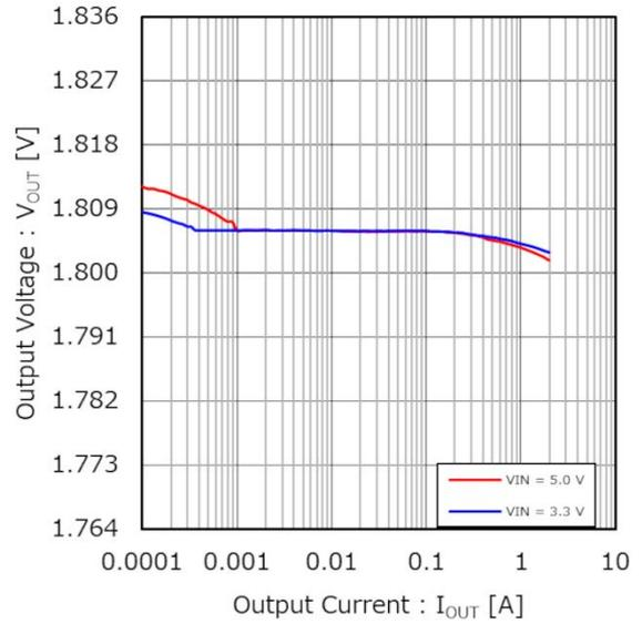
Figure 37. 出力電圧 vs 出力電流 (ロードレギュレーション)
