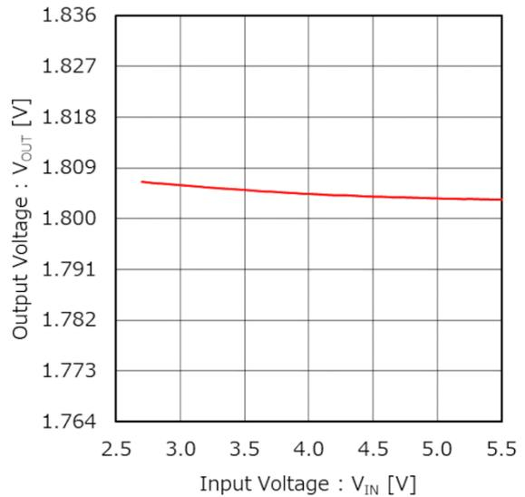
Figure 43. 出力電圧 vs 入力電圧 (ラインレギュレーション) (V<sub>OUT</sub> = 1.8 V, I<sub>OUT</sub> = 1.0 A)
