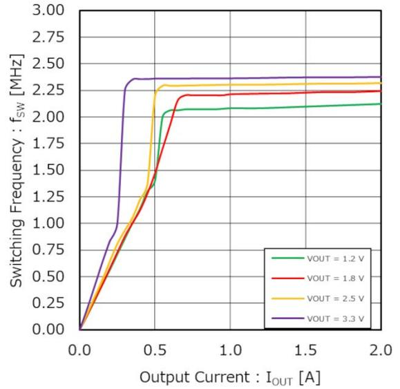
Figure 41. スイッチング周波数 vs 出力電流 (V<sub>IN</sub> = 5.0 V)
