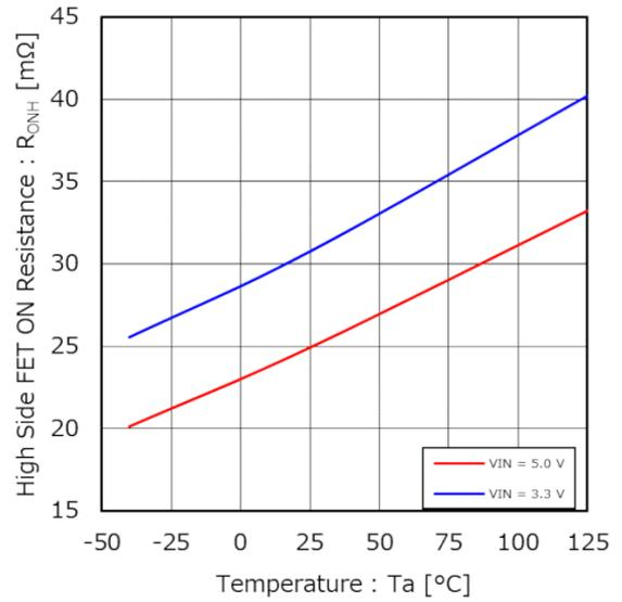
Figure 10. High Side FET ON 抵抗 vs 温度
