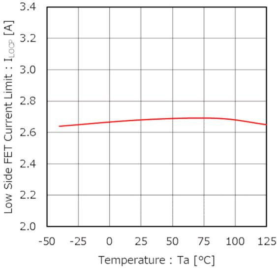
Figure 13. Low Side FET 電流制限 vs 温度
