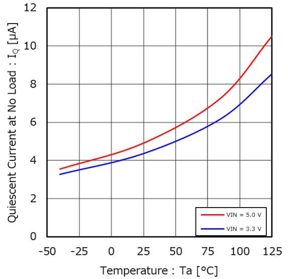
Figure 2. 無負荷時静止電流 vs 温度
