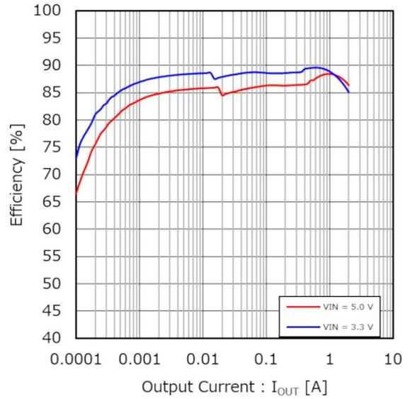
Figure 29. 効率 vs 出力電流
