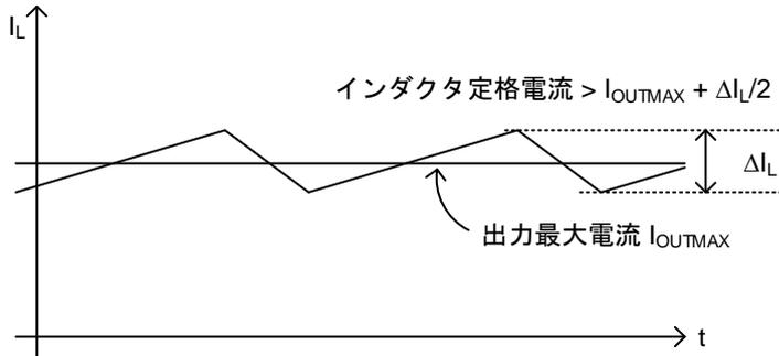
Figure 25. インダクタに流れる電流波形
