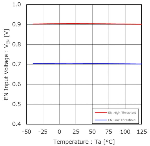
Figure 4. EN 入力電圧 vs 温度
