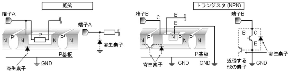
Figure 73. モノリシック IC 構造例
