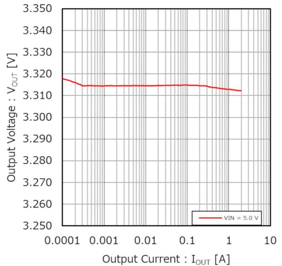
Figure 39. 出力電圧 vs 出力電流 (ロードレギュレーション)
