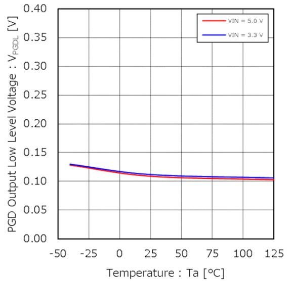
Figure 16. PGD 出力 Low Level 電圧 vs 温度
