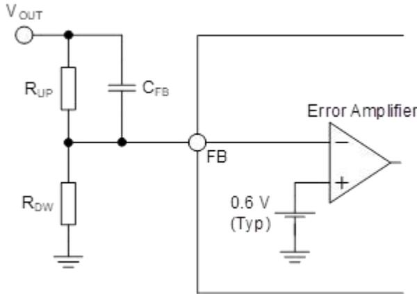
Figure 24. フィードバック抵抗回路
