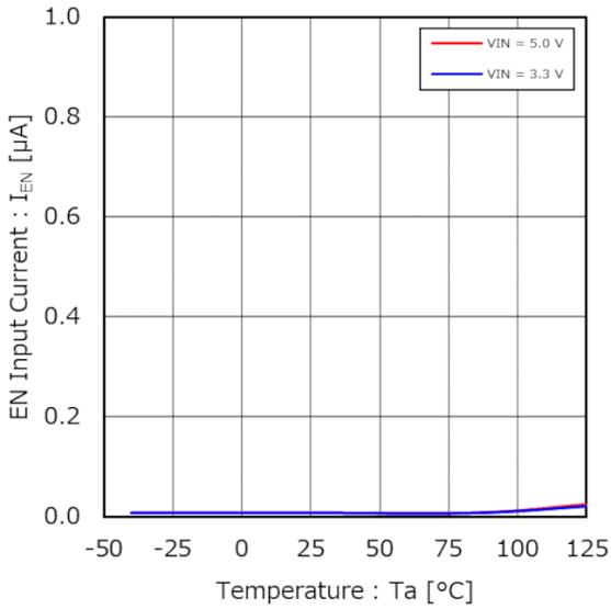
Figure 5. EN 流入電流 vs 温度
