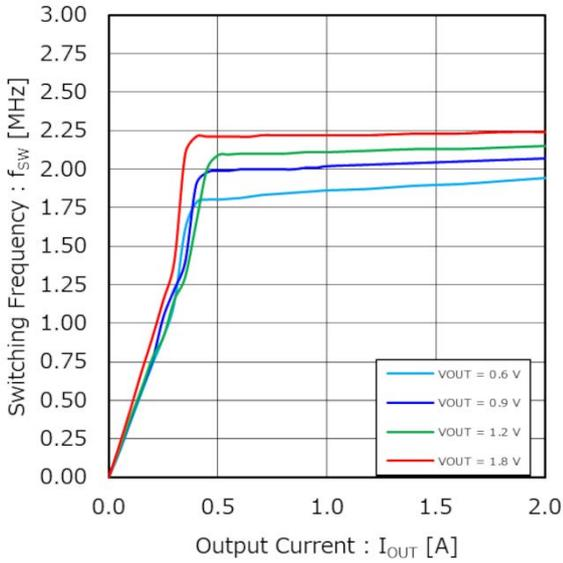
Figure 40. スイッチング周波数 vs 出力電流 (V<sub>IN</sub> = 3.3 V)
