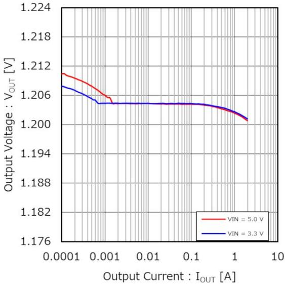
Figure 36. 出力電圧 vs 出力電流 (ロードレギュレーション)
