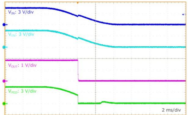
Figure 63.  $R_{Load} = 0.9\ \Omega$  VIN シャットダウン波形
