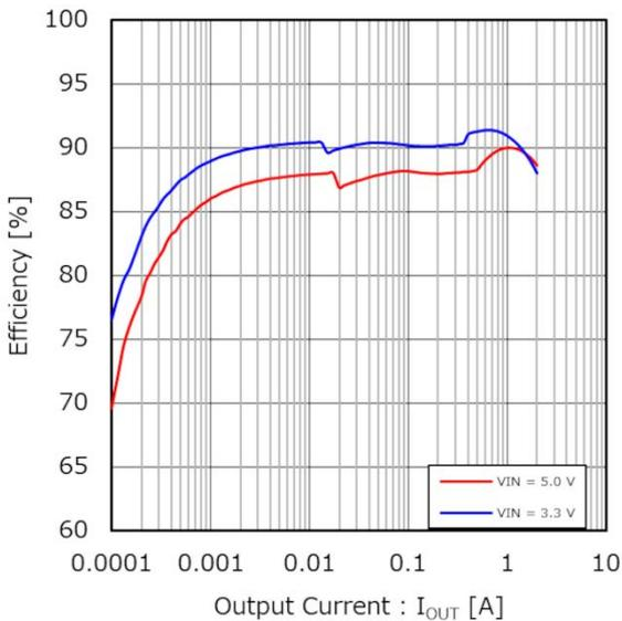
Figure 30. 効率 vs 出力電流
