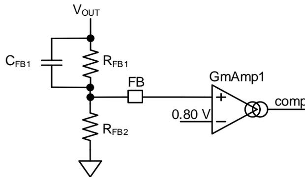
Figure 39. 出力電圧設定抵抗
