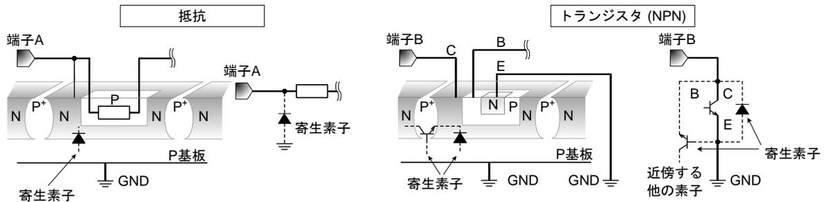
Figure 106. モノリシック IC 構造例
