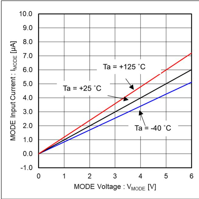
Figure 9. MODE 流入電流 vs MODE 入力電圧
