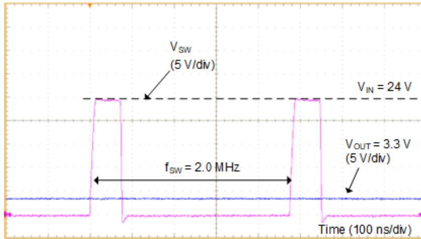
Figure 24. スイッチング波形 ( $V_{IN} = 24$  V、 $V_{OUT} = 3.3$  V、 $I_{OUT} = 1.0$  A、 $f_{SW} = 2.0$  MHz)
