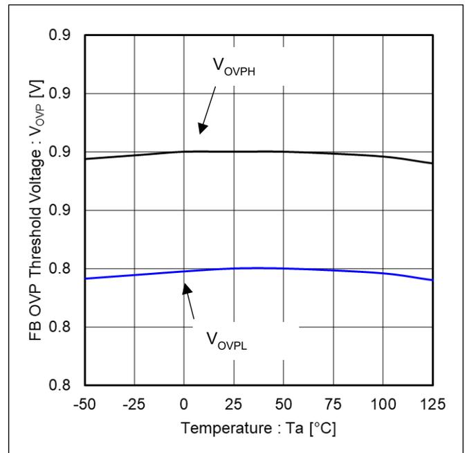
Figure 16. FB OVP スレッシュOLD電圧 vs 温度
