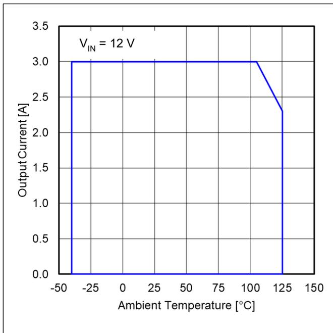
Figure 72. 出力電流 vs 周囲温度<sup>(Note 1)</sup>
