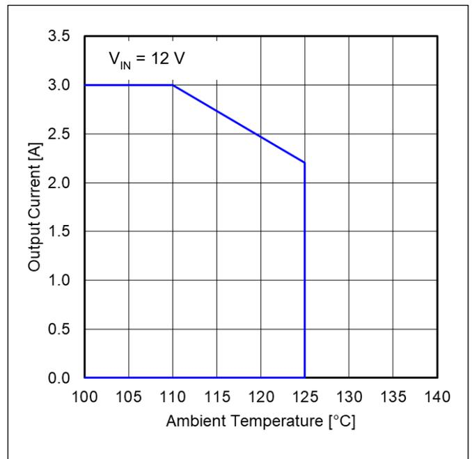
Figure 56. 出力電流 vs 周囲温度<sup>(Note 1)</sup>
