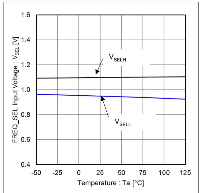
Figure 8. FREQ\_SEL 入力電圧 vs 温度
