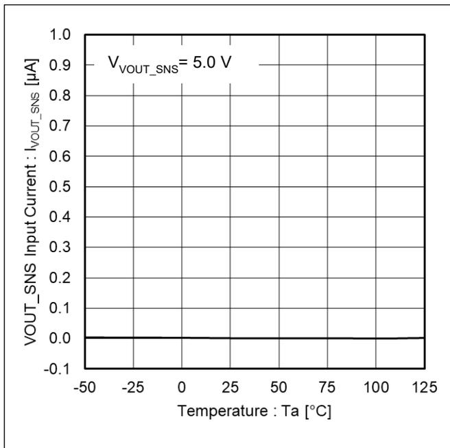
Figure 23. VOUT\_SNS 流入電流 vs 温度
