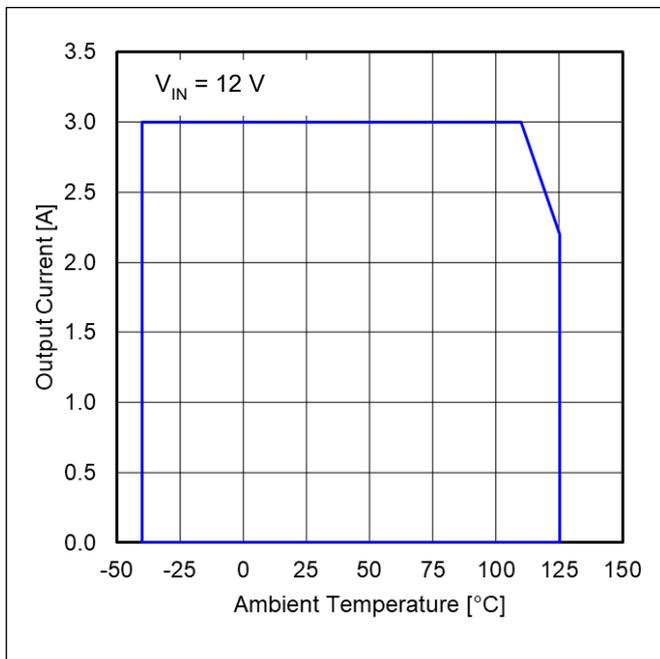
Figure 55. 出力電流 vs 周囲温度<sup>(Note 1)</sup>
