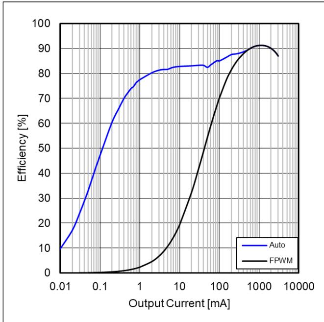
Figure 41. 効率 vs 出力負荷電流
