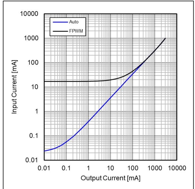
Figure 59. 入力電流 vs 出力負荷電流
