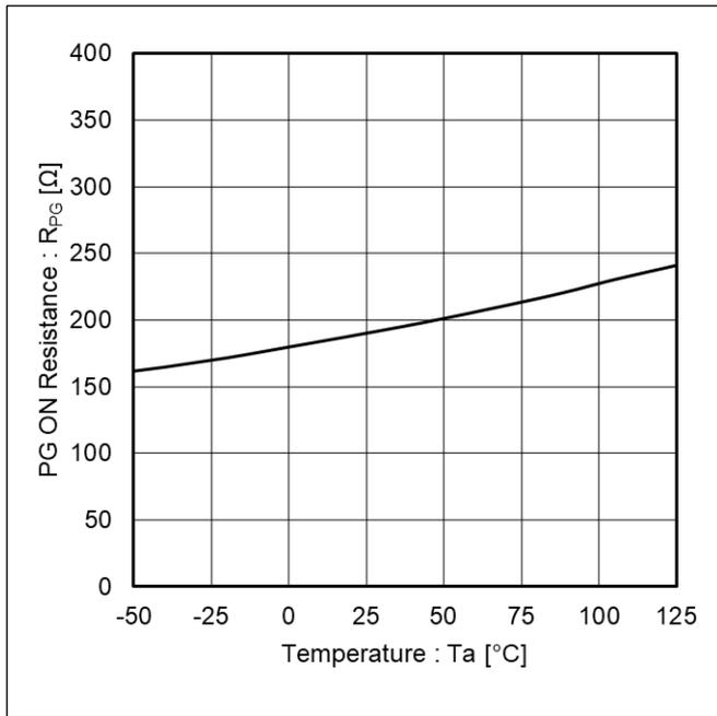
Figure 21. PG ON 抵抗 vs 温度
