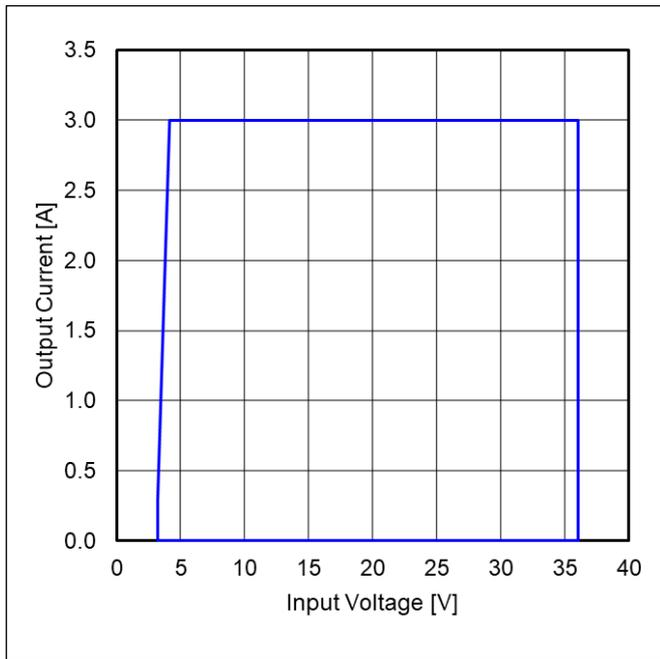
Figure 70. 出力電流 vs 入力電圧<sup>(Note 1)</sup>
