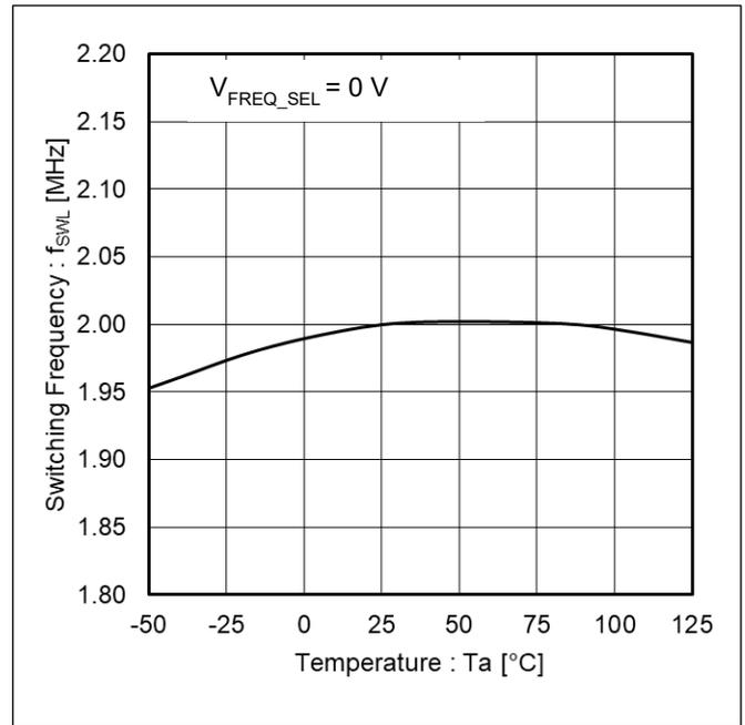
Figure 12. スイッチング周波数( $f_{SWL}$ ) vs 温度
