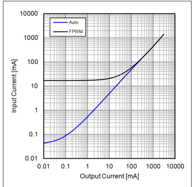
Figure 42. 入力電流 vs 出力負荷電流
