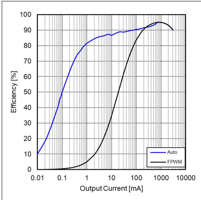
Figure 75. 効率 vs 出力負荷電流
