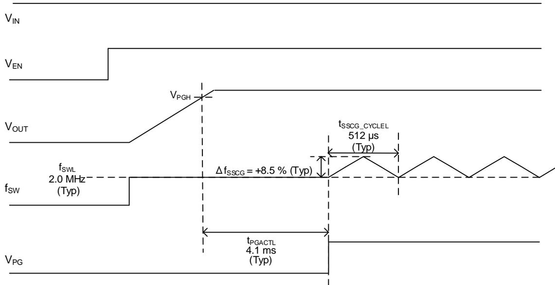
Figure 31. スペクトラム拡散機能 (FREQ\_SEL = L)
