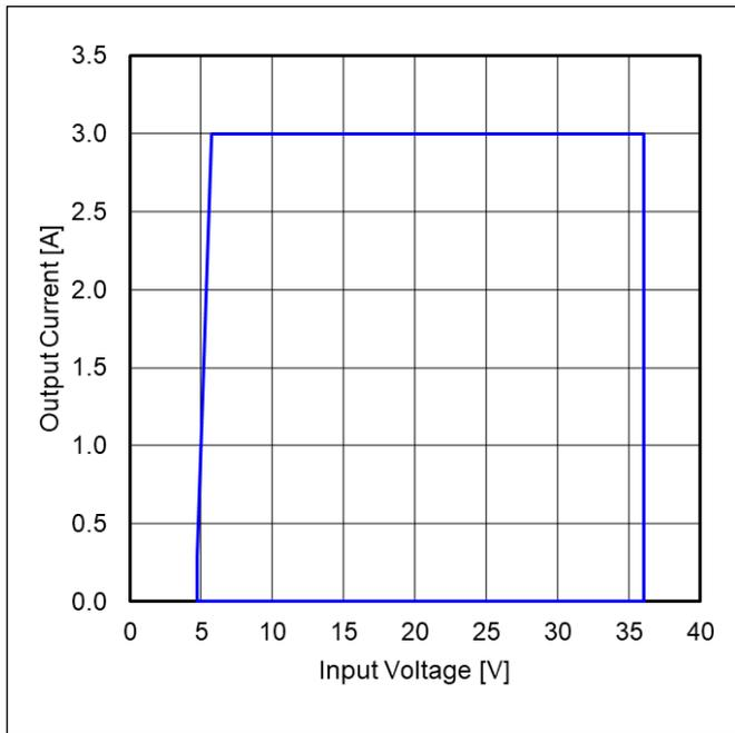
Figure 53. 出力電流 vs 入力電圧<sup>(Note 1)</sup>
