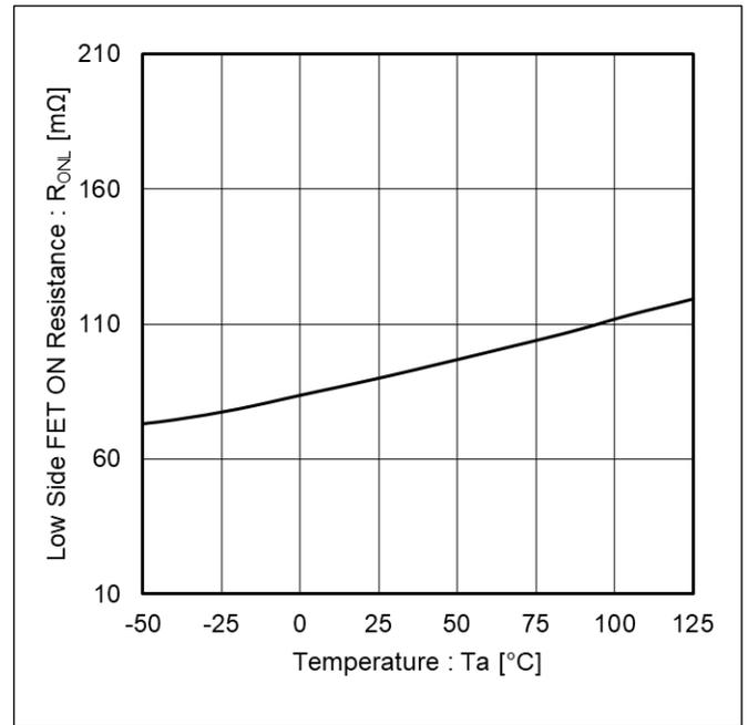
Figure 14. Low Side FET ON 抵抗 vs 温度
