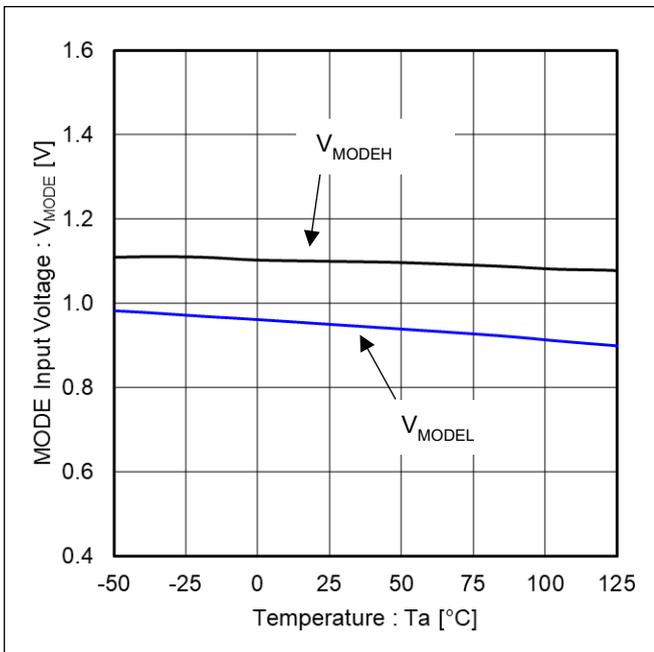
Figure 7. MODE 入力電圧 vs 温度
