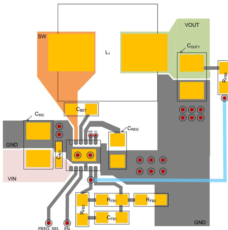
Figure 104. 推奨基板レイアウト例
