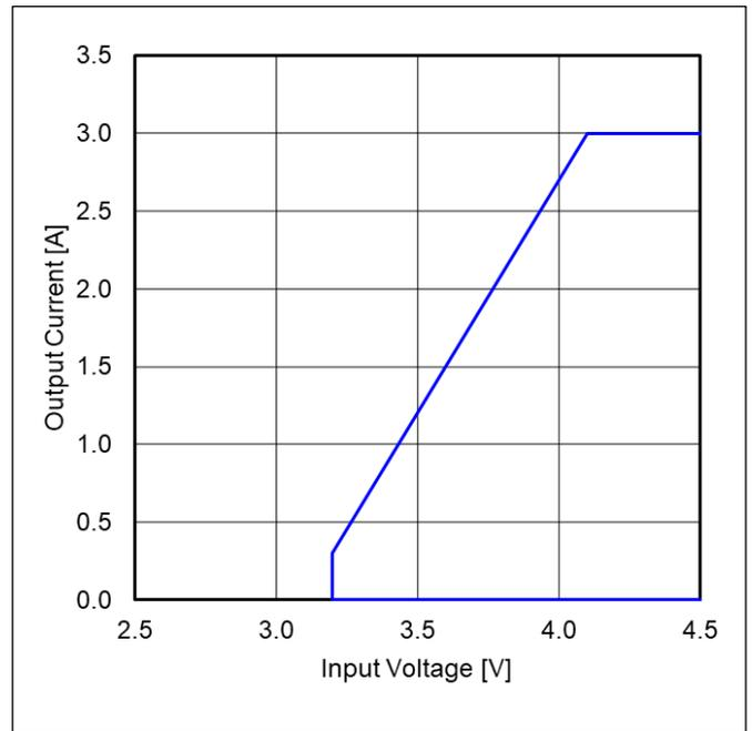
Figure 71. 出力電流 vs 入力電圧<sup>(Note 1)</sup>
