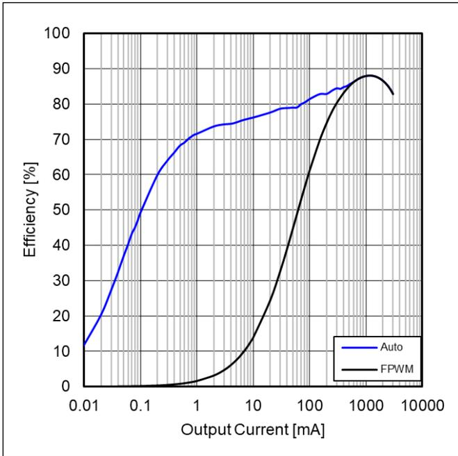
Figure 58. 効率 vs 出力負荷電流
