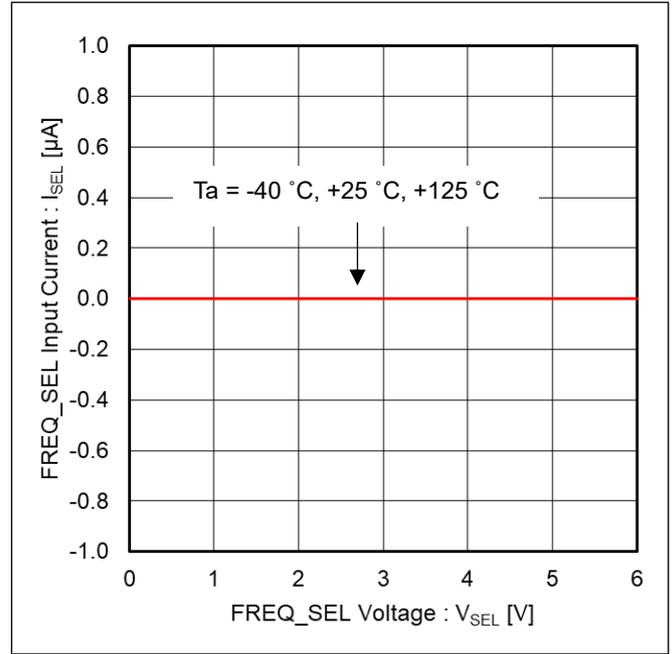
Figure 10. FREQ\_SEL 流入電流 vs FREQ\_SEL 入力電圧
