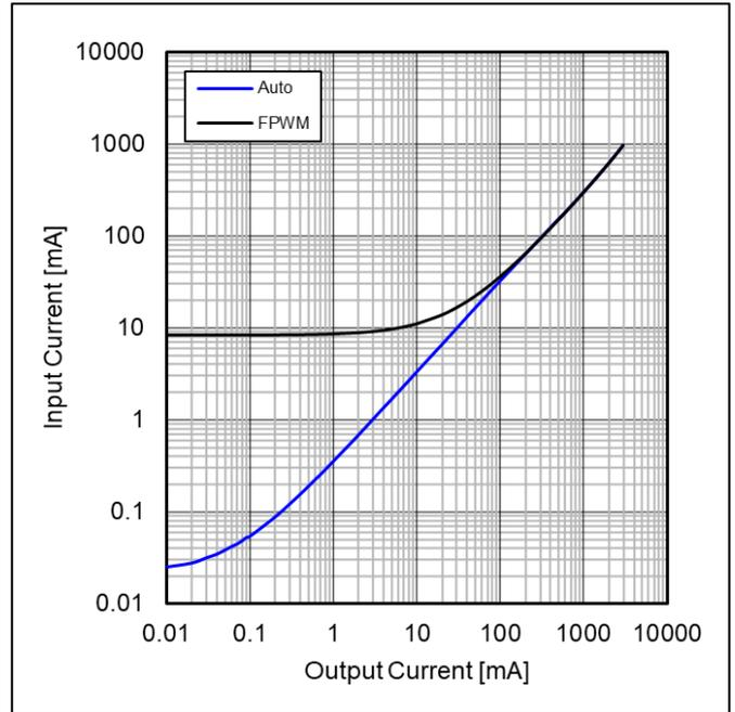
Figure 89. 入力電流 vs 出力負荷電流
