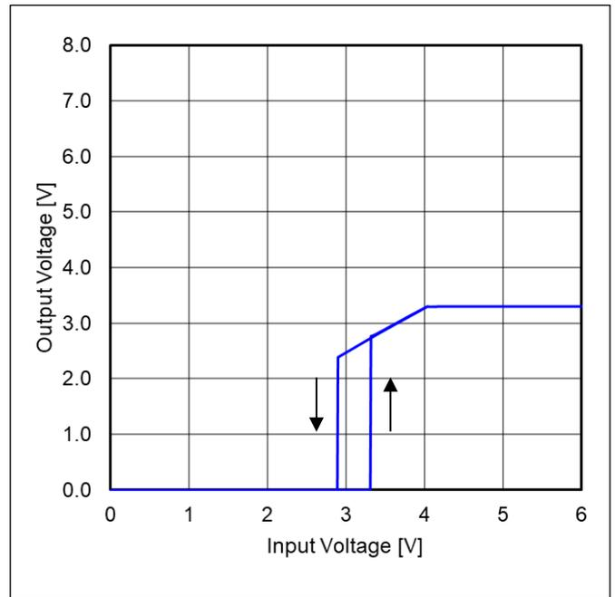
Figure 97. 出力電圧 vs 入力電圧
