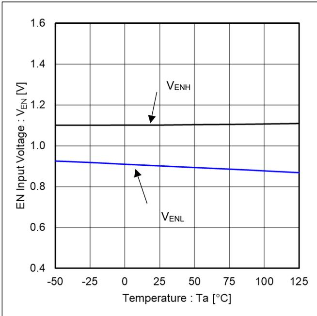
Figure 5. EN 入力電圧 vs 温度
