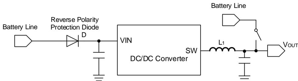
Figure 37.  $V_{OUT}$  とバッテリーラインの短絡
