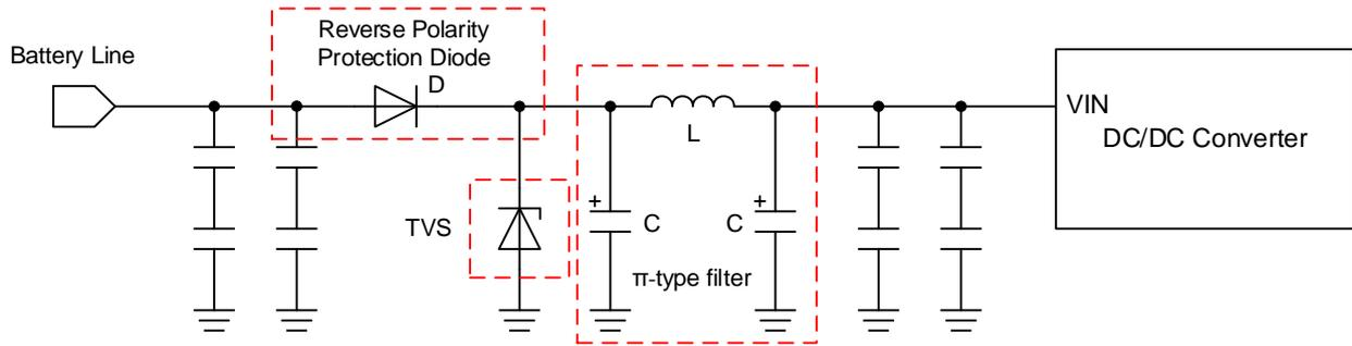
Figure 100. 車載電源供給ライン回路例
