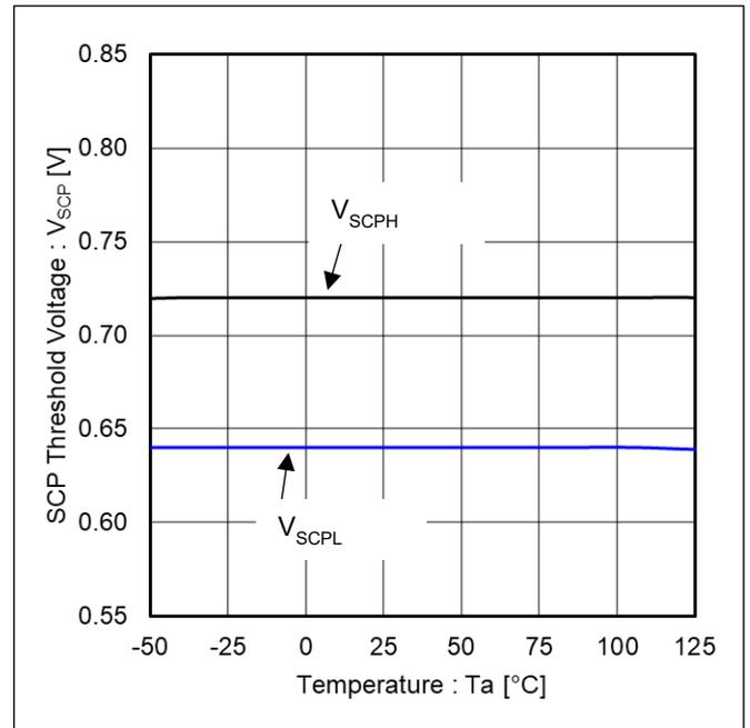
Figure 18. SCP スレッシュォルド vs 温度
