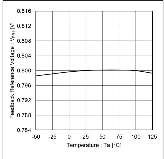
Figure 2. フィードバック電圧 vs 温度
