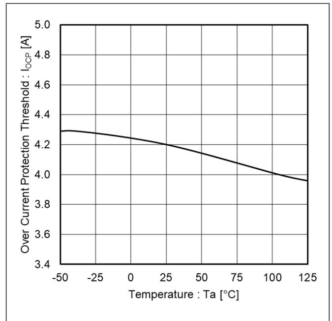
Figure 20. 過電流保護スレッシュォルド vs 温度
