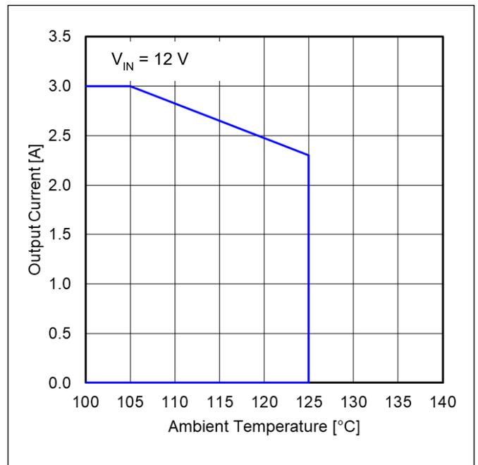
Figure 73. 出力電流 vs 周囲温度<sup>(Note 1)</sup>
