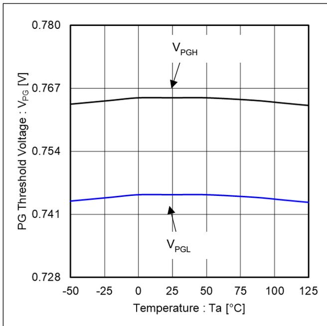
Figure 15. PG スレッシュOLD電圧 vs 温度
