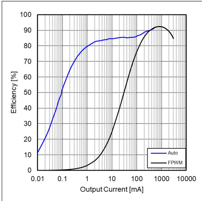
Figure 88. 効率 vs 出力負荷電流
