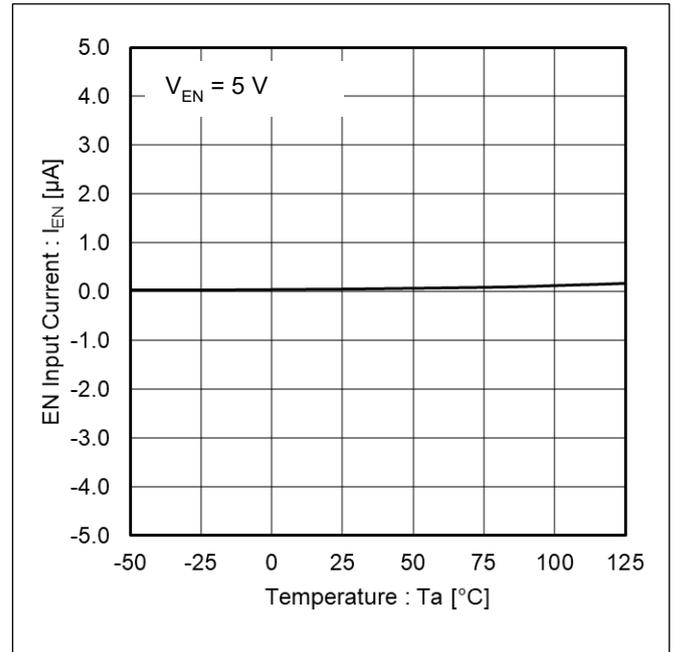
Figure 6. EN 流入電流 vs 温度
