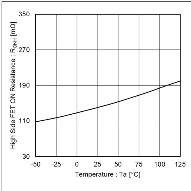
Figure 13. High Side FET ON 抵抗 vs 温度
