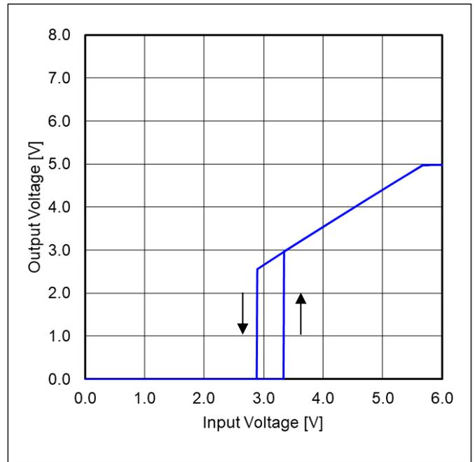
Figure 50. 出力電圧 vs 入力電圧
