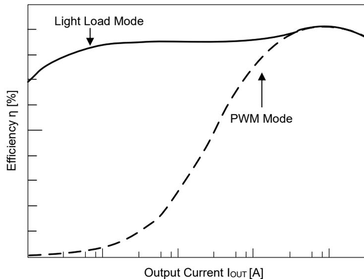
Figure 25. 効率 (Light Load Mode、PWM Mode)
