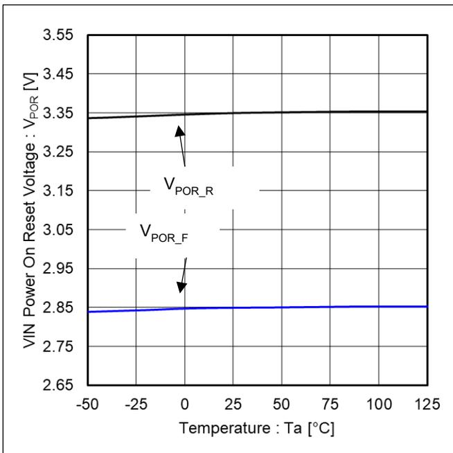
Figure 3. VIN POR 電圧 vs 温度
