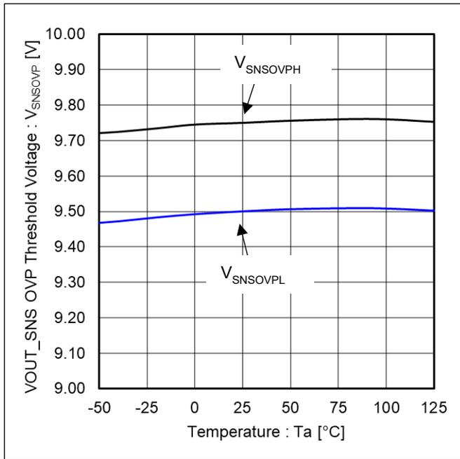
Figure 17. VOUT\_SNS OVP スレッシュォルド vs 温度
