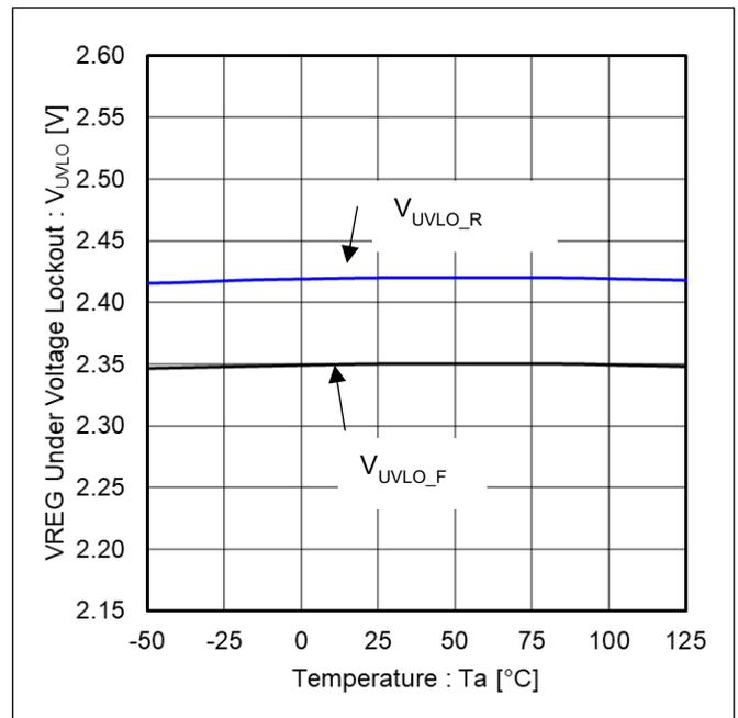
Figure 4. VREG UVLO 電圧 vs 温度
