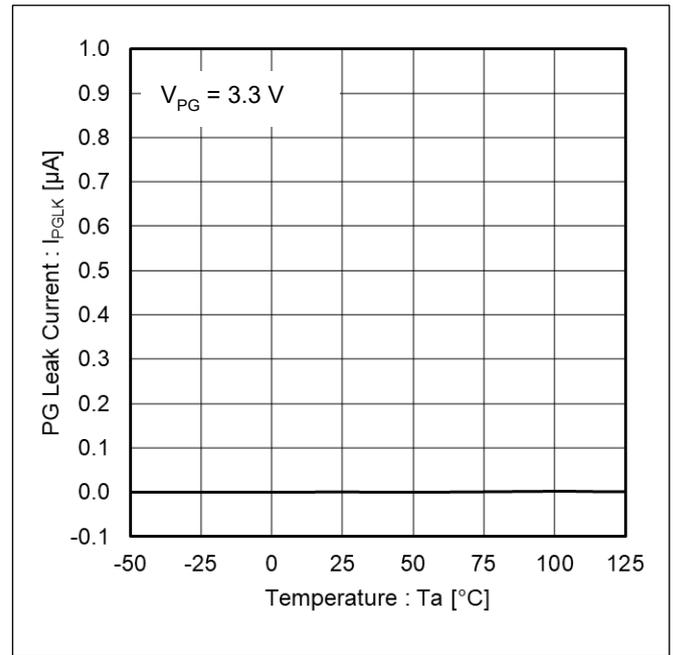
Figure 22. PG リーク電流 vs 温度
