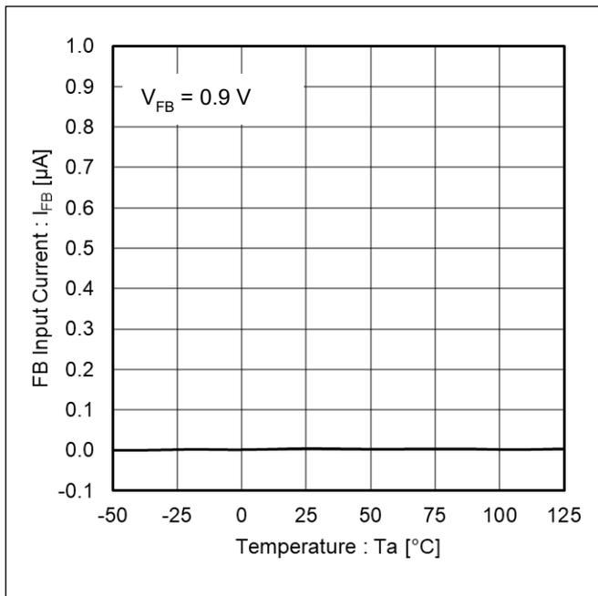
Figure 19. FB 流入電流 vs 温度
