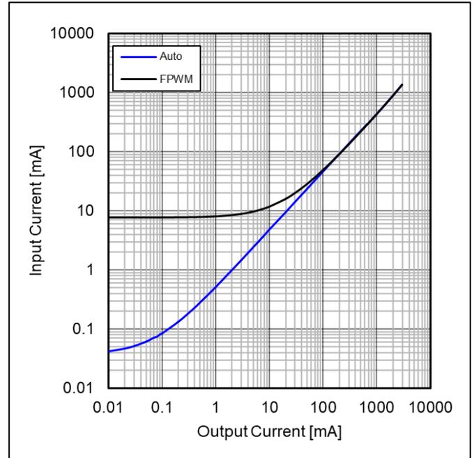
Figure 76. 入力電流 vs 出力負荷電流
