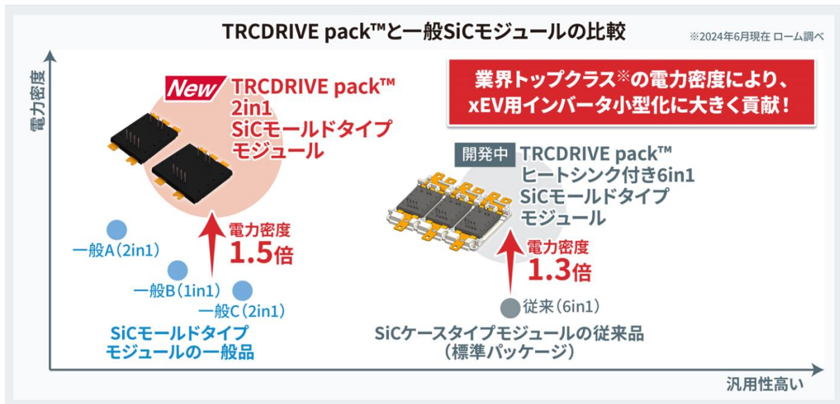
図 2：業界最高クラス※の電力密度を実現した TRCDRIVE pack™
