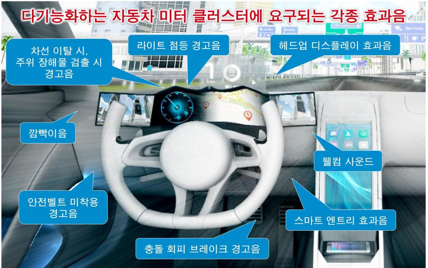
그림 1. 다기능화하는 자동차 미터 클러스터에 요구되는 각종 효과음
