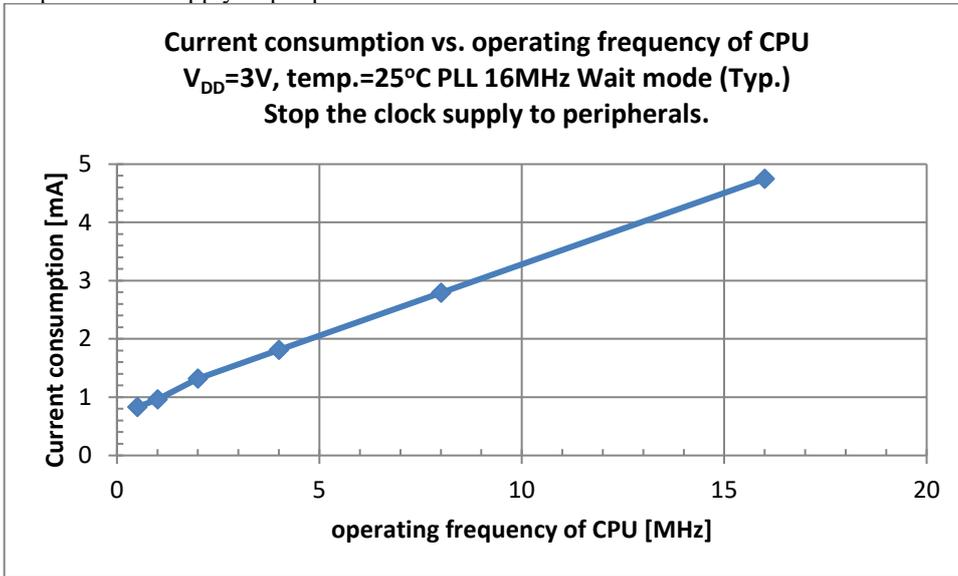
$V_{DD}=3V$ , temp.=25°C PLL 16MHz no Wait mode (Typ.)
