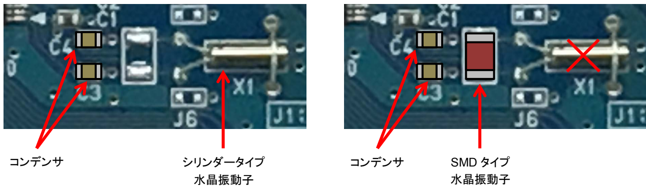
図 5 水晶振動子廻りの加工例
