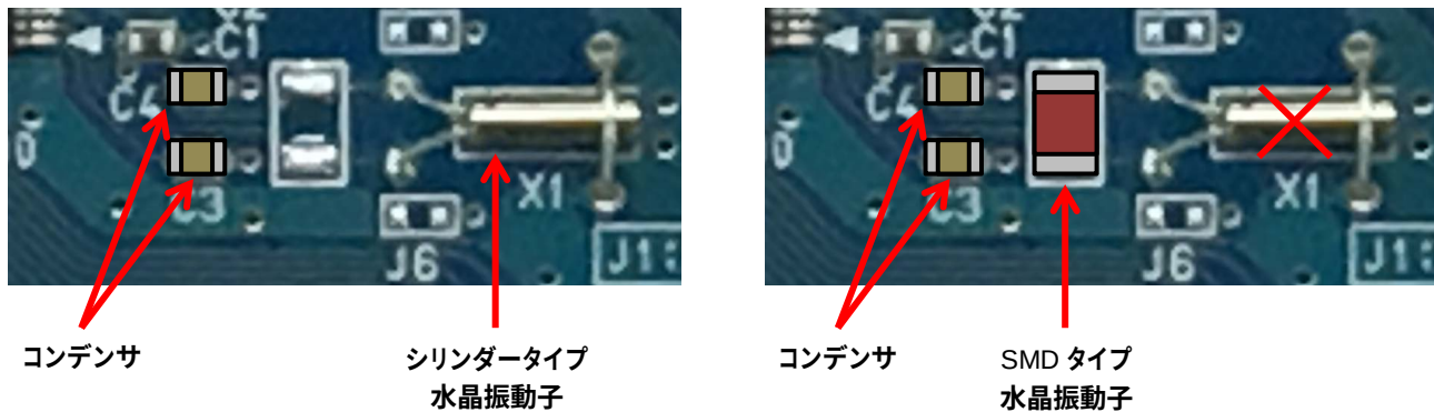
図 5 水晶振動子廻りの加工例
