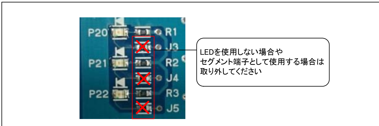
図 4. LED 廻りの加工例
