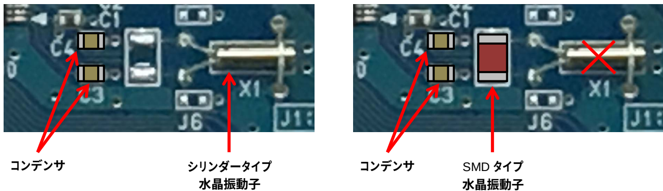
図 5 水晶振動子廻りの加工例
