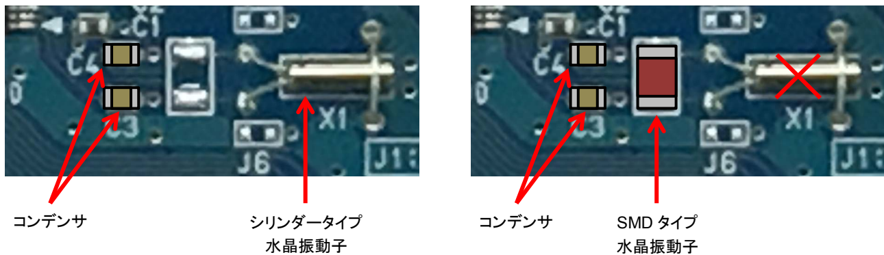
図 5 水晶振動子廻りの加工例
