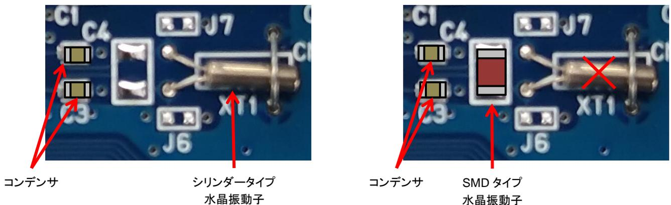
図 5 水晶振動子廻りの加工例
