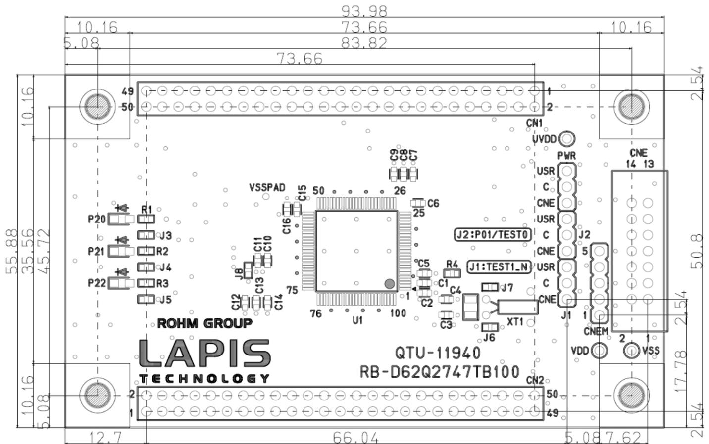
図 7 RB-D62Q2747TB100 基板寸法図 (Top View)
