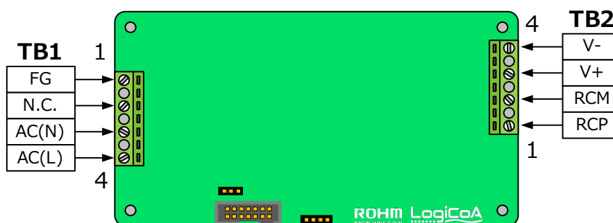
Figure 6-2. 入力用コネクタ TB1、出力用コネクタ TB2 端子配置
