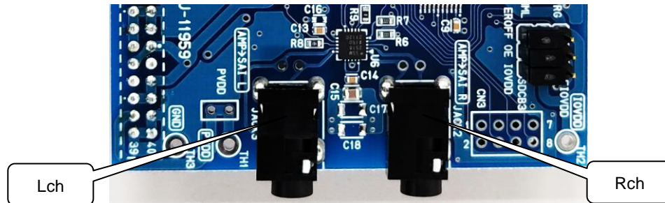
図 2 SAI ジャックの Lch/Rch 実装位置
